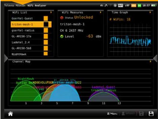
Cette fonctionnalité effectue une analyse complète de l'ensemble de la bande Wi-Fi (2,4 et 5 GHz), afin de trouver, d'identifier et de mesurer tous les réseaux Wi-Fi disponibles. A cet effet, MOSAIQ6 offre 4 fonctions d'analyse différentes :
