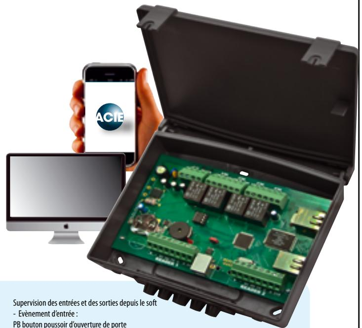
Alimentation extérieure 12vDC et POE pour la connexion IP
