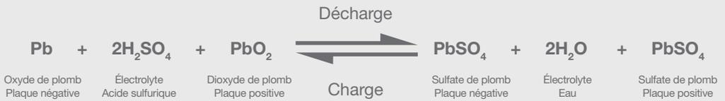
Décharge : le dioxyde de plomb (PbO<sub>2</sub>) est converti en sulfate de plomb (PbSO<sub>4</sub>) au niveau des plaques positives. Le plomb (Pb) est converti en sulfate de plomb (PbSO<sub>4</sub>) au niveau des plaques négatives. Ceci provoque une consommation d'acide sulfurique (H<sub>2</sub>SO<sub>4</sub>).
