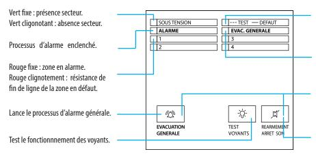
Jaune clignotant : la centrale est en mode essai Jaune fixe et buzzer : ligne de DM ou de DS en dérangement.
