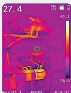
1. Repérez facilement et efficacement les mauvaises connexions ou les surchauffes dans une armoire électrique en détectant les points chauds.
